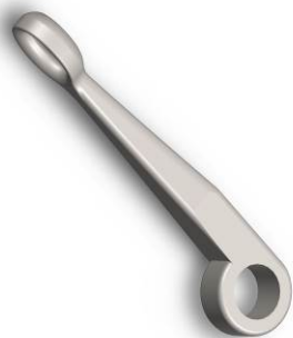
фиг. 3 Тримерно изображение на конструираното езиче.
