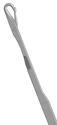
фиг. 9 Увеличено изображение на куката и езичето на иглата.
