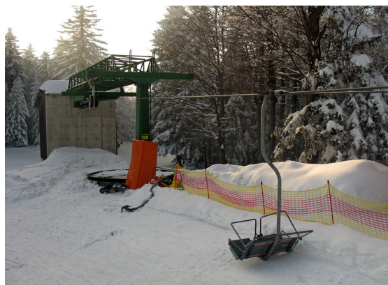
фиг.4 Паднала обръщателна шайба на двуседалков лифт
