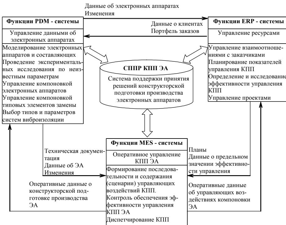
рис.1 Концептуальная модель автоматизированного управления конструкторской подготовки производства электронных аппаратов
