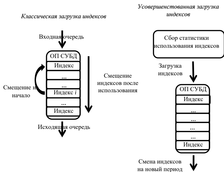
рис. 2. Сравнение алгоритмов загрузки индексов в оперативную память
