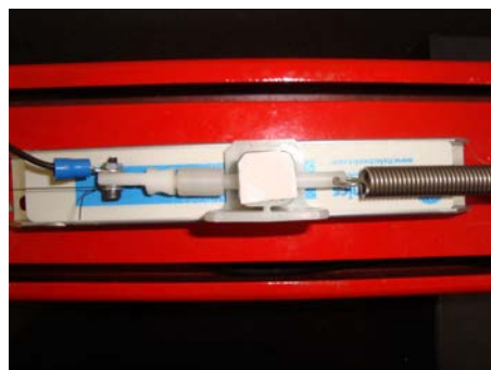
фиг. 3 Магнитен безконтактен сензор за преместване тип APO-075-001
