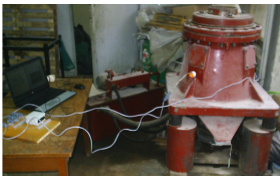
фиг.5 Измервателна система и разположение на акселерометъра върху КИД-300
