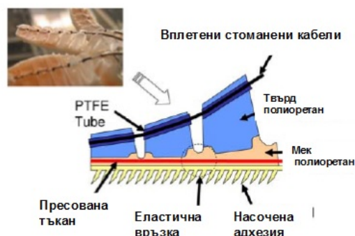
фиг.5 Схема на пръста на "StickyBot" в разрез[1]
