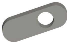
фиг.8 Лява планка за задвижване на десният снемашия клин за образуване на примка.
