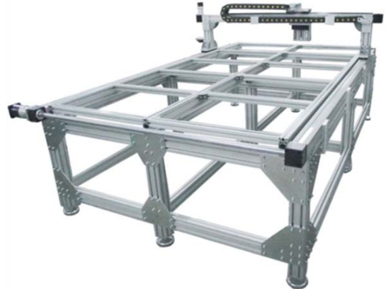
фиг.5 Корпусна конструкция от алуминиеви профили
