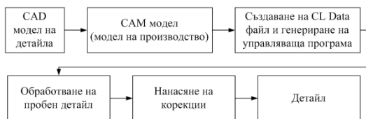
Фиг.1 Етапи на технологичната подготовка с обработване на пробен детайл
