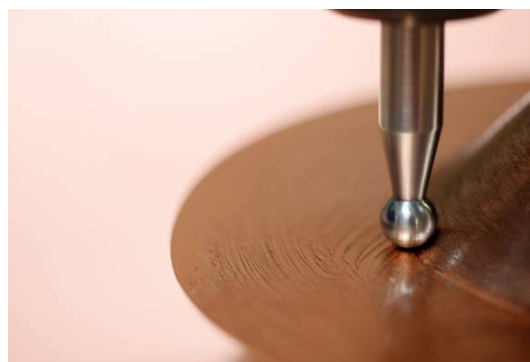
фиг. 5 Оформяне на фин ламаринен диск по калъп, със CNC машина – за абажур на осветително тяло; дизайнер – Emil Froege, в лабораторията SPACE10
