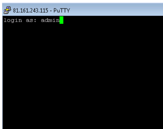
фиг.3 Стартиране на SSH сесия с безжичния рутер MikroTik
