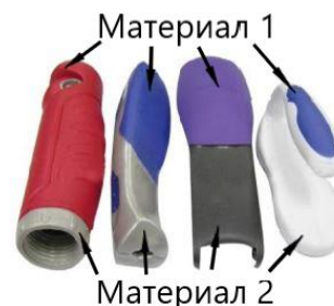
фиг.2 Многократно шприцване (Multi-shot Molding)
