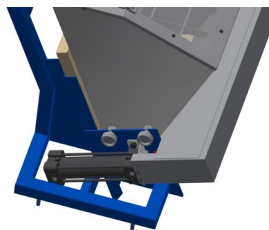
фиг. 2в 3D модел с изглед от подаващите цилиндри
