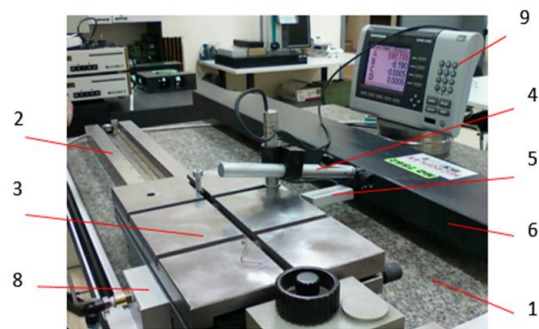
фиг.2 Опитна установка за калибриране на еталон за праволинейност по реверсивен метод – позиция 0°
